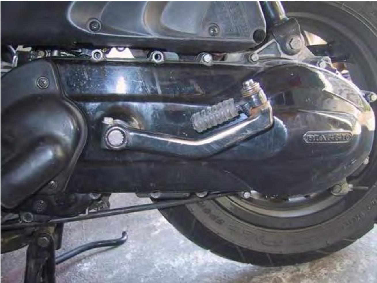
**2. Variotool von Buzetti mit einer Schraube fixieren. Den Kreuzschraubenzieher durch das obere Loch stecken und nach rechts hebeln, so dass das Variotool gegen das Lüfterrad gedrückt wird und dieses blockiert. Dabei dann mit der 18er Nuss + Ratsche die Variomutter lösen und die Unterlegscheiben, Sternscheibe und Lüfterrad abnehmen.**
